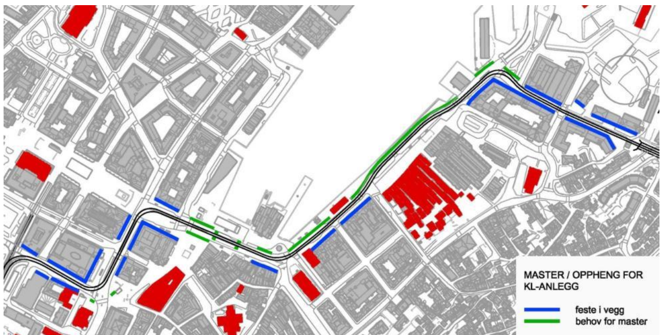
Figur 4: Illustrasjon av mulig plassering av master og oppheng for kontaktledningsnett for Bybanen i alternativ 1Aa. Bygninger som er markert røde er fredet.
